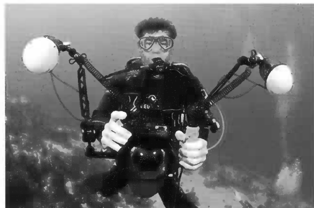
Photographe équipé de flashes D2000 reliés par fibres optiques comportant des diffuseurs hémisphériques.
